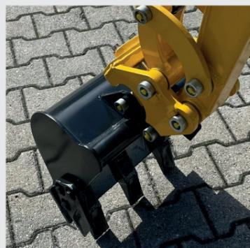
Solide Umlenkung + Löffelwechsler
