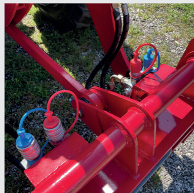
Schnellwechsler für schnelles Tauschen der Anbauwerkzeuge
