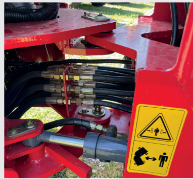
Hydraulische Knicklenkung & Pendelachse hinten für mehr Flexibilität und Bodenhaftung.
