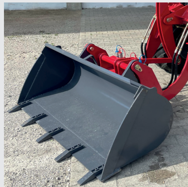
Inklusive 0,5 m³ große Erdschaufel mit abnehmbaren Zähnen
