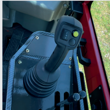
Joystick-Steuerung und elektronische Gangschaltung
