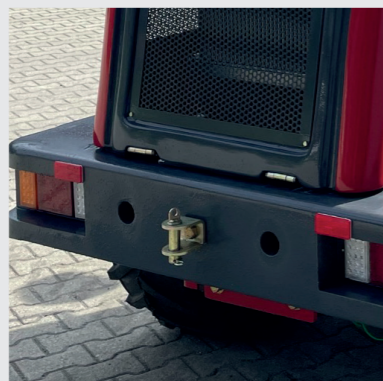
Zugmaul für leichten Transport von Anhängern und vielem mehr.
